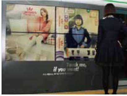
▲ 지하철 2호선에 설치된 투명 디스플레이, 대화형 광고패널로, 소비자가 직접 터치하여 원하는 정보를 얻을 수 있다.
