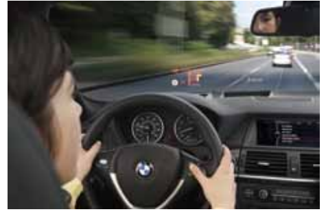
▲ BMW사가 개발한 자동차용 헤드업 디스플레이, 운전 중 자연스럽게 계기판을 볼 수 있어 안전운전을 돕는다.
