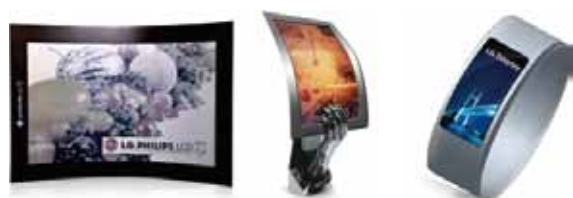
▲ LG디스플레이가 개발한 컬러 플렉서블 전자종이와 플렉서블 AMOLED
