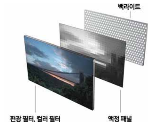
▲ 일반 LCD의 구조 원리. 투명 디스플레이는 여기에서 백라이트 부분이 투명 백라이트로 대체되었다고 이해하면 된다. (사진 출처 : IT 동아)
