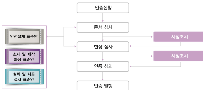
그림 4 안전설계, 소재 및 제작과정, 설치 및 시공절차 표준안을 통한 인증 절차
