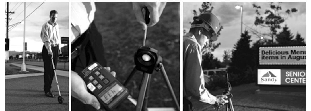
그림2 룩스미터를 사용한 빛 측정 과정
