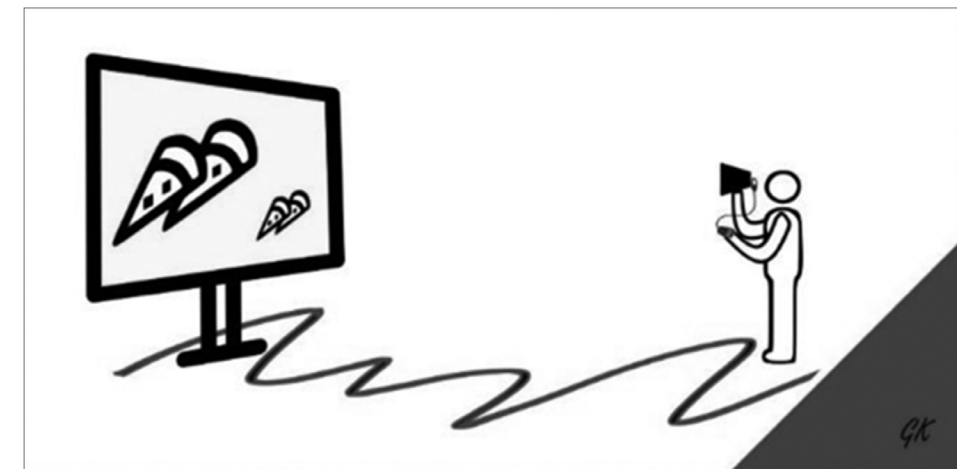
[그림4] 측정: 피라미드 모양 틀과 룩스미터를 사용한 측정 - 전광판 밝기 + 주변 밝기의 값 획득
