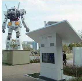
▲ 태양광으로 집적된 에너지가 디지털 사이니지를 구동한다. 맑은 날 5시간 충전하면, 10시간 동안 방영이 가능하다.
