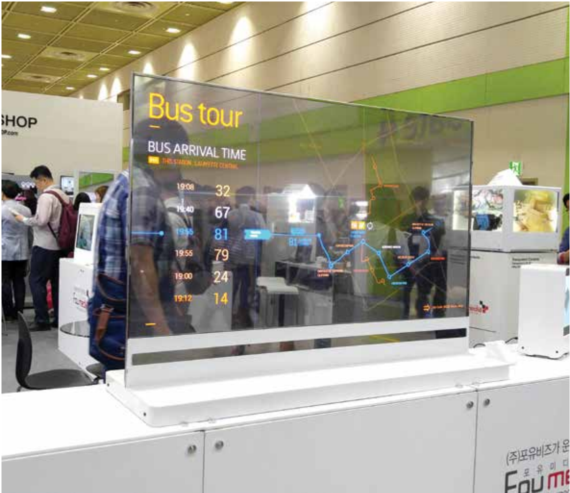
그림 5 시인성이 개선된 투명 디스플레이
